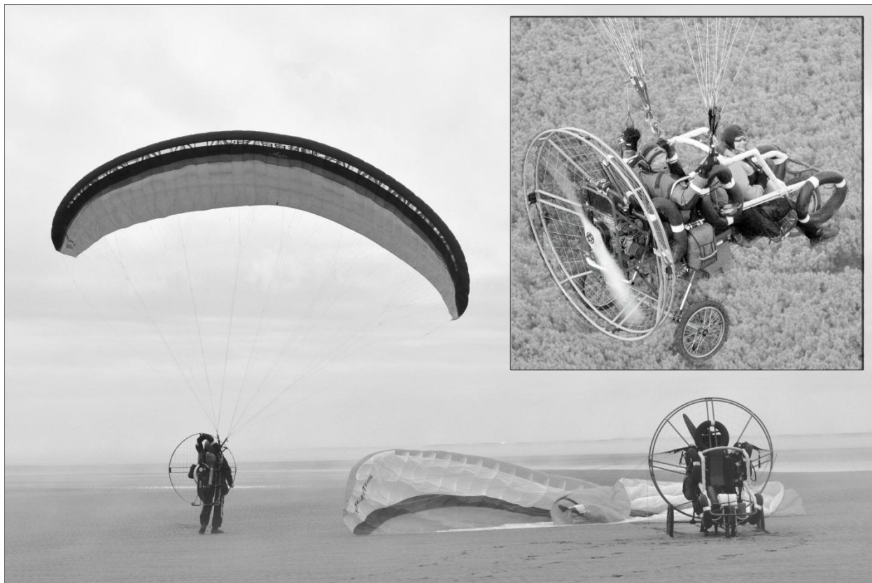
Рис. 1. Варианты конструкции парамотора: слева – с tandemным сидением для пилота и пассажира (взлет «с ног»), справа и на врезке – с 2х-местной тележкой.
