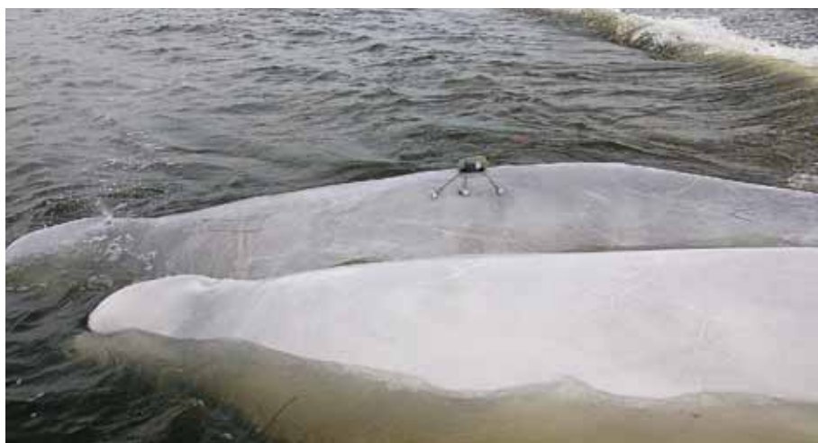
Рис. 1. Радиомаяк «Пульсар» спутниковой системы Argos, установленный на белухе (© Д.М. Глазов)
